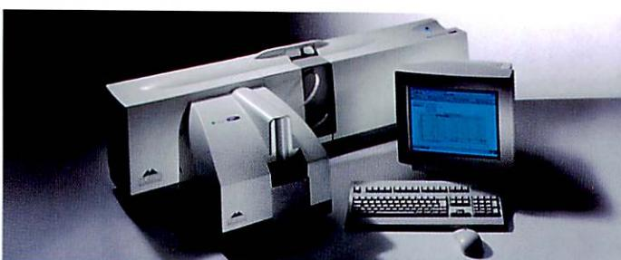
測定原理 : Mie理論に基づくレーザー回折・散乱法
